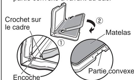
\* Si la partie convexe du bac est recouverte par le matelas, le cadre se détachera facilement.
